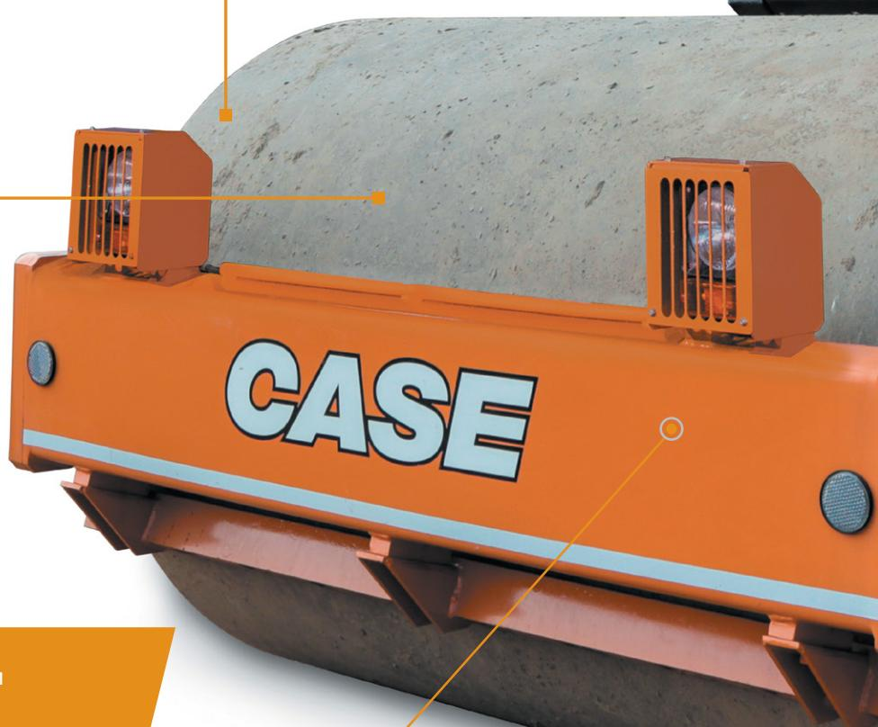
Центробежная сила создается внутренним эксцентриковым валом и вращающимся грузом: в зависимости от направления вращения груза он находится или в одной фазе с эксцентриковым валом (для максимальной центробежной силы), или в противофазе (для минимальной центробежной силы).
