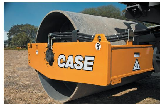
В состав системы привода вальца входит дополнительный высокомоментный гидромотор, установленный на раме переднего вальца. Он обеспечивает превосходную способность машины преодолевать уклоны (36% в непрерывном режиме и 40% в прерывистом), а также гарантирует оптимальное тяговое усилие.
